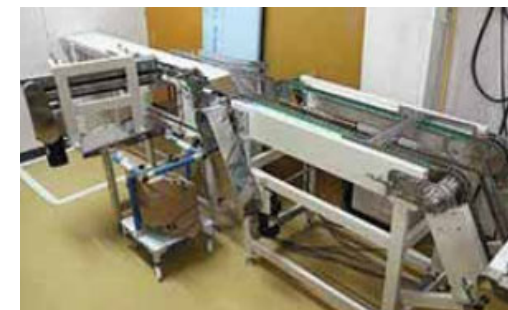
高速微振動型シフター導入による 製麺ラインの成形工程自動化
